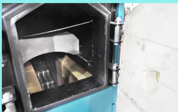
Degšanas kamera pārklāta ar ugunsizturīgu materiālu un aprīkota ar kustīgo ārdūņu sistēmu, kas palielina sadegšanas efektivitāti.
